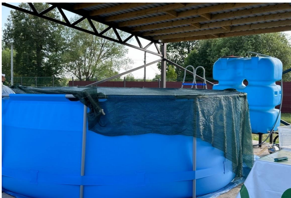
Рисунок 1 – Замкнутая система с биофильтром для проведения опыта
